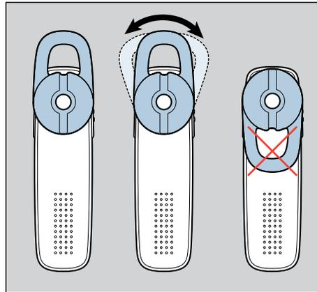
イヤーチップを外すには、イヤーチップのループ部分を引いて、スピーカーの軸部分から外します（スピーカーのハウジン部や軸部は引っ張らないでください）。
