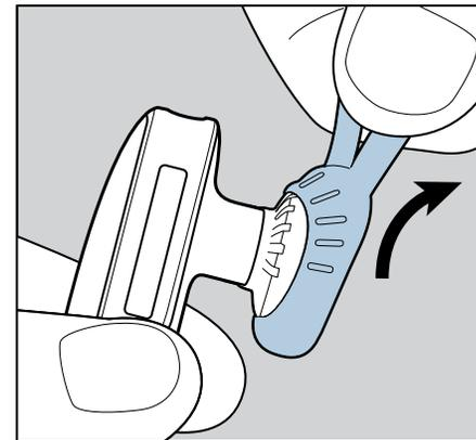
新しいイヤーチップの底をスピーカーに差し込み、イヤーチップを引っ張ってスピーカーにかぶせます（スピーカーをジェルイヤーチップに押し込まないでください）。
